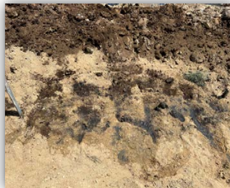
Сурет 3 - Баянды кентінің жанындағы полигонның мұнаймен ластанған топырағы
